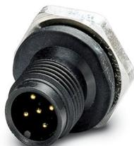
Conector de montagem sensor/atuador, plugue, 5 pólos, M12, codificação A, montagem frontal de painel/a parafuso com rosca M16, com pino de solda, versão de plástico
