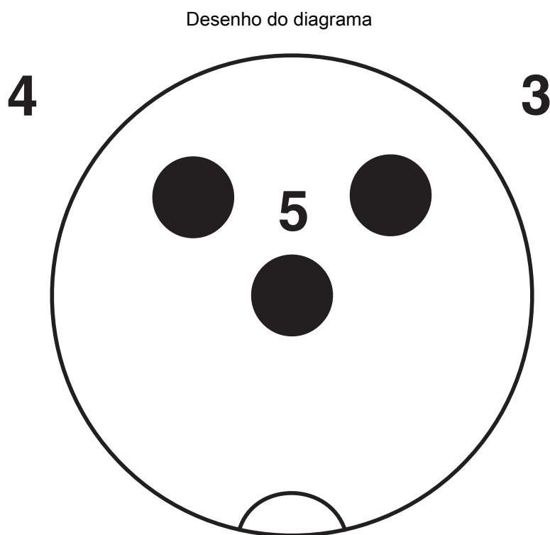
Imagem com pólos plugue M12, 3 pólos, conector para válvula
