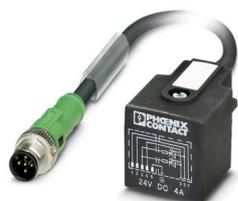
Cabo para sensor/atuador, 5-polos, PUR sem halogênio, preto acinzentado RAL 7021, Conector reto M12 SPEEDCON, codificação: A, com 2 LEDs, para Conector de válvula AD (pressostato), com 2 LEDs, Ligação: sem ligação, comprimento de cabo: 3 m
