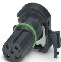
Porta-contatos, 5-polos, Soquete, angular, M12, B-codificação, Solda por onda, espera-se que esse artigo seja isento de chumbo a partir de 2026-Q2, de acordo com RoHS II, sem exceção 6c (Pb < 0,1%); alternativa sem chumbo possível mediante solicitação antecipada
