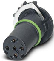
Porta-contatos, 5-polos, Soquete, reto, M12, A-codificação, Conexão soldável THR, espera-se que esse artigo seja isento de chumbo a partir de 2026-Q1, de acordo com RoHS II, sem exceção 6c (Pb < 0,1%); alternativa sem chumbo possível mediante solicitação antecipada
