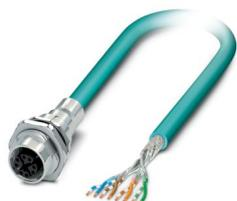
Conector de encaixe para equipamento parede posterior, Ethernet CAT6<sub>A</sub> (10 GBit/s) CAT6<sub>A</sub>, 8-polos, PUR, azul anil RAL 5021, blindado, Soquete, reto, M12-SPEEDCON, X-codificação, para extremidade livre do condutor, Linha de bus, comprimento de cabo: 5 m, Ethernet 10 GBit, espera-se que esse artigo seja isento de chumbo a partir de 2026-Q2, de acordo com RoHS II, sem exceção 6c (Pb < 0,1%); alternativa sem chumbo possível mediante solicitação antecipada
