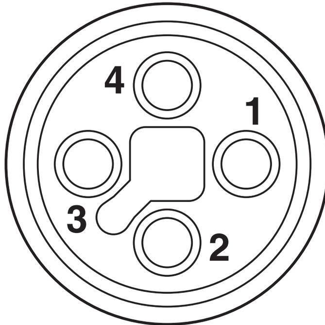
Definição das conexões, soquete M12, 4 polos, codificação T, vista lateral do soquete
