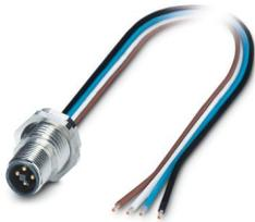
Conector de encaixe para equipamento parede posterior, Potência, 4-polos, Pino, reto, M12-Padrão, T-codificação, para extremidade livre do condutor, Cabos individuais, comprimento de cabo: 0,5 m, 1,31 mm<sup>2</sup>, Fio de controle UL/cUL, encapsulado, espera-se que esse artigo seja isento de chumbo a partir de 2026-Q2, de acordo com RoHS II, sem exceção 6c (Pb < 0,1%); alternativa sem chumbo possível mediante solicitação antecipada
