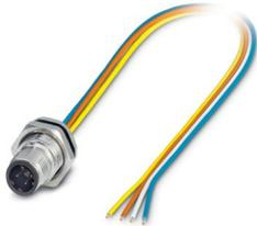
Conector de encaixe para equipamento parede posterior, PROFINET CAT5 (IEC 11801:2002), 4-polos, Pino, reto, M12-Padrão, D-codificação, para extremidade livre do condutor, Cabos individuais, comprimento de cabo: 0,5 m, 0,34 mm<sup>2</sup>, Cabo TPE, encapsulado, espera-se que esse artigo seja isento de chumbo a partir de 2026-Q1, de acordo com RoHS II, sem exceção 6c (Pb < 0,1%); alternativa sem chumbo possível mediante solicitação antecipada
