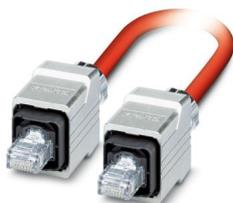
Cabo Sercos III, blindado, quadrante em estrela, AWG 22 flexível (7 fios), RAL 3020 (vermelho), conector RJ45/IP67 push-pull, caixa metálica sobre conector RJ45/IP67, metal, codificação D, comprimento: 5 m
