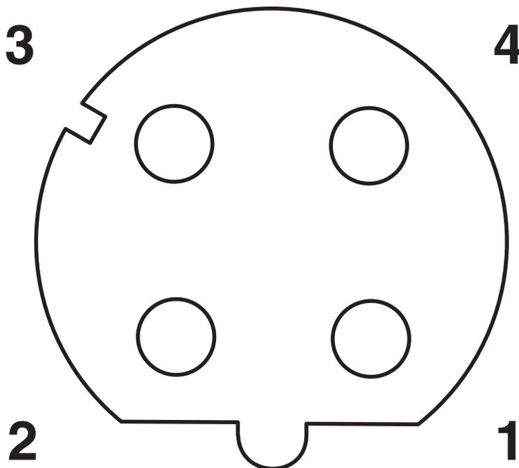
Imagem com polos soquete M12, 4 polos, codificação D, vista lado do soquete
