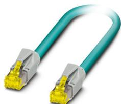
Cabo de interconexão, CAT6<sub>A</sub>, 4 pares, blindado, conexão não cruzada (Line), montado dos dois lados com conectores plugáveis RJ45/IP20, material revestimento externo: PUR, comprimento: 1,0 m
