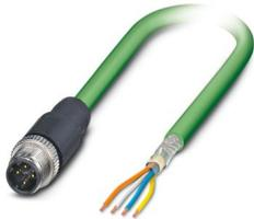
Cabo de rede, PROFINET CAT5 (100 MBit/s), 4-polos, PUR sem halogênio, verde RAL 6018, Conector reto M12, codificação: D / IP67, para extremidade livre do condutor, comprimento de cabo: 2 m
