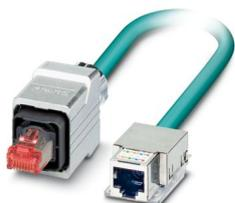
Cabo Ethernet montado, CAT6, blindado, 4 pares, AWG 26 flexível (7 fios), RAL 5021 (azul), módulo de soquete RJ45/IP20 para sistema Freenet, 8 pólos sobre conector RJ45/IP67 push-pull caixa metálica, Line, comprimento 5 m
