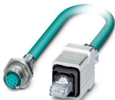
Cabo Ethernet montado, blindado, 4 pares, AWG 26 adequado para correia de arraste (19 fios), RAL 5021 (azul água), soquete de montagem M12, montagem na parede posterior/com parafusos com rosca M16 sobre conector RJ45/IP67, caixa metálica push-pull, Line, comprimento: 2 m
