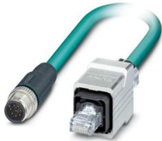
Cabo de rede, Ethernet CAT5 (1 GBit/s), 8-polos, PUR sem halogênio, azul anil RAL 5021, Conector reto M12, codificação: A / IP67, para Conector reto RJ45 Push-Pull / IP67, comprimento de cabo: 2 m
