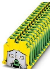
Borne terra, No alinhamento em terminal de passagem com o mesmo contorno, com tensões de isolamento > 250 V é preciso aplicar uma placa de isolamento de seções, quantidade de conexões: 2, tipo de conexão: Conexão a parafuso, 1. nível, perfil de conexão: 0,5 mm<sup>2</sup> - 10 mm<sup>2</sup>, tipo de fixação: Base PE com parafuso de fixação, M4, tipo de montagem: NS 15, cor: verde-amarelo
