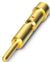
Contato para crimp, série: VARIOCON, Pino, Girado, diâmetro de contato: 1 mm, bitola de conexão: 0,14 mm<sup>2</sup> ... 0,5 mm<sup>2</sup>, AWG 26...20, material de contato: Cu, espera-se que esse artigo seja isento de chumbo a partir de 2026-Q1, de acordo com RoHS II, sem exceção 6c (Pb < 0,1%); alternativa sem chumbo possível mediante solicitação antecipada
