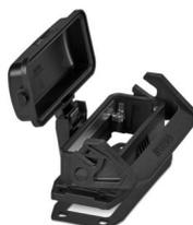
Caixa de montagem exterior B16, com trava simples, material: PA 6.6-FR, material capa de proteção: PC, altura: 30,5 mm, conexão para cabos: sem, tampa de proteção: sim, Padrão, com vedação plana
