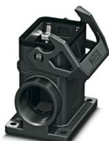
Caixa de base B6, com trava simples, material: PA 6.6-FR, saídas de cabos: 2, lateral, 2x M32, altura: 74 mm, conexão para cabos: sem, Padrão
