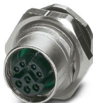
Conector de encaixe para equipamento parede posterior, Ethernet CAT5 (IEC 11801:2002) (100 MBit/s), 8-polos, Soquete, reto, M12-SPEEDCON, Y-codificação, Solda por onda, espera-se que esse artigo seja isento de chumbo a partir de 2026-Q1, de acordo com RoHS II, sem exceção 6c (Pb < 0,1%); alternativa sem chumbo possível mediante solicitação antecipada
