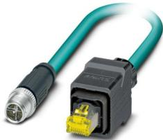
Cabo de rede, Ethernet CAT6<sub>A</sub> (10 GBit/s), CC-Link IE CAT6<sub>A</sub> (10 GBit/s), 8-polos, PUR sem halogênio, azul anil RAL 5021, blindado (Advanced Shielding Technology), Conector reto M12 SPEEDCON, codificação: X / IP67, para Conector reto RJ45 Push-Pull / IP67, comprimento de cabo: 5 m
