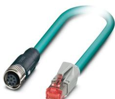
Cabo de rede, Ethernet CAT5 (1 GBit/s), 8-polos, PUR sem halogênio, azul anil RAL 5021, blindado, Conector reto RJ45 / IP20, para Soquete reto M12 SPEEDCON, codificação: A / IP67, comprimento de cabo: 1 m
