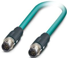
Cabo de rede, Ethernet CAT5 (1 GBit/s), 8-polos, PUR sem halogênio, azul anil RAL 5021, blindado (Advanced Shielding Technology), Conector reto M12, codificação: A / IP67, para Conector reto M12, codificação: A / IP67, comprimento de cabo: 5 m
