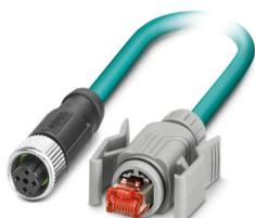
Cabo de rede, Ethernet CAT5 (100 MBit/s), 4-polos, PUR sem halogênio, azul anil RAL 5021, blindado, Soquete reto M12 SPEEDCON, codificação: D / IP67, para Conector reto RJ45 Travamento com grampo / IP67, comprimento de cabo: 2 m
