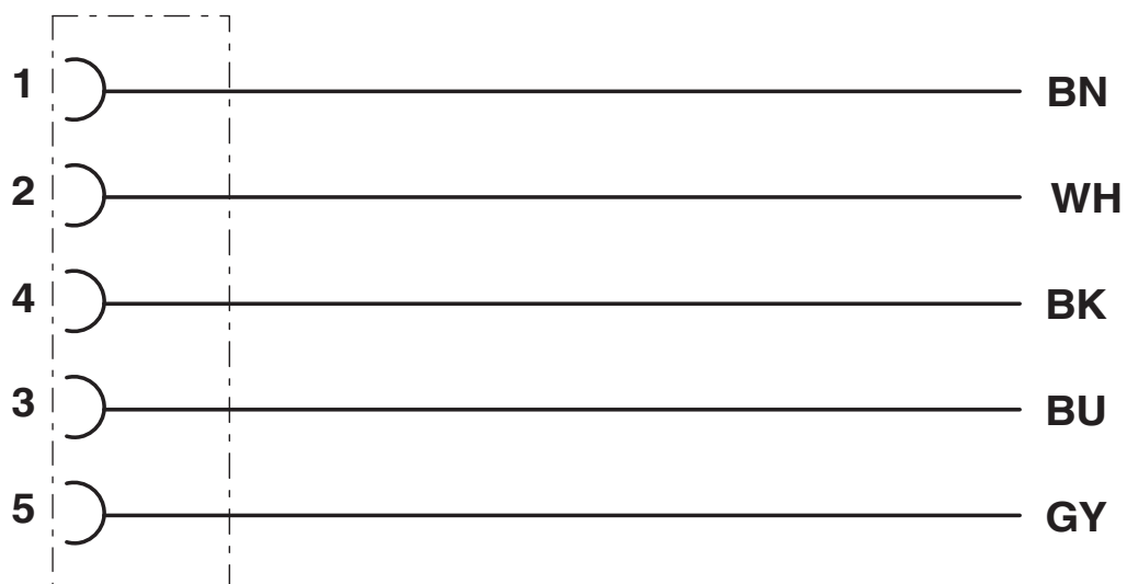
Esquema de ligação do plugue M12 e do soquete M12
