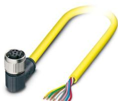
Cabo para sensor/atuador, 8-polos, PVC, amarelo, extremidade livre do condutor, para Soquete angular M12, codificação: A, comprimento de cabo: 5 m
