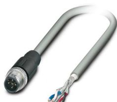
Cabo de sistema Bus, CANopen®, DeviceNet™, 5-polos, PVC, cinza, blindado, Conector reto M12, codificação: A, para extremidade livre do condutor, comprimento de cabo: 2 m, Conector de encaixe não blindado
