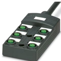
Caixa de distribuição, tipo de conexão: Conector M12 Plástico, número de pontos de encaixe: 6, número de polos: 4, codificação: A, atribuição do ponto de encaixe: simples, indicação de estado: sim, npn; conexão do cabo padrão: Conexão fixa 180°, PUR/PVC, comprimento do cabo: 5 m, blindagem: não
