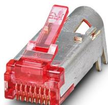
Elemento de pino RJ45, CAT6, 8 polos, blindado, tecnologia de conexão Pierce IDC, para fios AWG 27 ... 24, com alívio de tração
