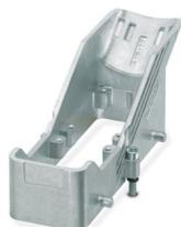
Moldura de montagem de conectores HEAVYCON, parte superior para trava dupla, para partes inferiores com trava dupla HC-CIF...BFWD... ou para partes inferiores HC-CIF...BFFD..., para dois insertos de contato de formato B6, com parafusos M4 com cabeça sextavada interior de 3 mm, para trilhos de fixação NS35/7,5
