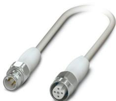
Cabo para sensor/atuador, 4-polos, PP-EPDM, cinza RAL 7035, Conector reto M12, codificação: A, para Soquete reto M12, codificação: A, comprimento de cabo: 0,6 m, Design higiênico, com serrilha de aço inoxidável
