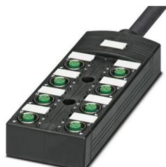
Caixa de distribuição, aplicação: Robôs e porta-cabos, tipo de conexão: Conector M12 Metal, número de pontos de encaixe: 8, número de polos: 5, codificação: A, atribuição do ponto de encaixe: duplo, indicação de estado: sim, PNP; conexão do cabo padrão: Conexão fixa 180°, PUR sem halogênio altamente flexível, altamente flexível, comprimento do cabo: 5 m, blindagem: não
