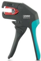
Ferramenta de decapagem, para cabos e condutores de 4 - 16 mm<sup>2</sup>, auto-ajustável, comprimento de decapagem até 18 mm, capacidade de corte flexível até 10 mm<sup>2</sup> / rígido 1,5 mm<sup>2</sup>, lâmina de decapagem substituível
