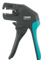
Ferramenta de decapagem, para cabos e condutores de 0,02 - 10 mm<sup>2</sup>, auto-ajustável, comprimento de decapagem até 18 mm, capacidade de corte flexível até 10 mm<sup>2</sup> / rígido 1,5 mm<sup>2</sup>, lâmina de decapagem substituível
