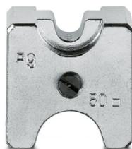
Matriz (parte inferior), para CRIMPFOX-C120, para terminais elétricos não isolantes (DIN 46234) 6 + 50 mm<sup>2</sup>, crimp Indent
