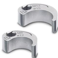
Coroa de encaixe para a montagem de cabos para sensor/atuador com conector M12 e de conectores M12 montáveis, com diâmetro serrilhado de 15 mm, para acionamento sextavado de 4 mm
