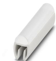
Porta-identificação de condutor, transparente, não impresso, faixa de diâmetro de cabo: 2 ... 3,5 mm, tipo de montagem: encaixar, altura do campo de texto: 4 mm, largura do campo de texto: 23 mm
