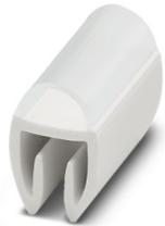
Porta-identificação de condutor, transparente, não impresso, faixa de diâmetro de cabo: 2 ... 3,5 mm, tipo de montagem: encaixar, altura do campo de texto: 4 mm, largura do campo de texto: 10 mm
