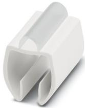
Porta-identificação de condutor, transparente, não impresso, faixa de diâmetro de cabo: 6,7 ... 10 mm, tipo de montagem: encaixar, altura do campo de texto: 4 mm, largura do campo de texto: 15 mm
