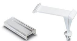
Porta-identificação de módulos Phoenix, para identificar módulos e placas de circuito impresso, para diâmetros de furo de 3,9 até 4,1 mm, espessura da parede ou placa 1,5 - 2,0 mm, etiquetagem com tiras de encaixe ESL, EST ou ES/LP-BW-GB, tamanho do campo para gravação: 29 x 8 mm
