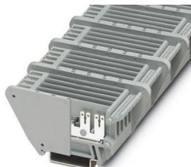
Borne de passagem, tensão nominal: 800 V, corrente nominal: 30 A, quantidade de conexões: 10, número de polos: 1, tipo de conexão: Conexão para conector plano, 1. nível, perfil de conexão: 0,5 mm<sup>2</sup> - 6 mm<sup>2</sup>, tipo de montagem: NS 35/7,5, NS 35/15, cor: cinza
