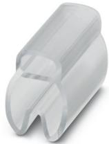
Porta-identificação de condutor, transparente, não impresso, faixa de diâmetro de cabo: 4 ... 7 mm, tipo de montagem: de enfiar, altura do campo de texto: 4 mm, largura do campo de texto: 12 mm
