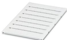
Marcador de terminais, disponível para pedido: em esteira, branco, identificado conforme dados do cliente, tipo de montagem: travamento em ranhura elevada de plaqueta, para a largura de terminal: 12 mm, Quantidade de plaquetas de identificação: 40, altura do campo de texto: 10,5 mm, largura do campo de texto: 11,45 mm
