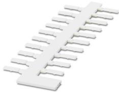
Identificador de cabos, disponível para pedido: em tiras, branco, identificado conforme dados do cliente, faixa de diâmetro de cabo: 0,6 ... 7 mm, tipo de montagem: inserção, altura do campo de texto: 4 mm, largura do campo de texto: 10 mm
