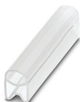
Porta-identificação de condutor, transparente, não impresso, faixa de diâmetro de cabo: 1,5 ... 2,5 mm, tipo de montagem: de enfiar, altura do campo de texto: 4 mm, largura do campo de texto: 30 mm
