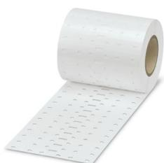
Identificador de cabos, Rolo, branco, não impresso, identificável com: THERMOMARK E.300 (D)/600 (D), THERMOMARK ROLL 2.0, THERMOMARK ROLL, THERMOMARK ROLL X1, THERMOMARK ROLLMASTER 300/600, THERMOMARK X1.2, faixa de diâmetro de cabo: 2 ... 3,5 mm, tipo de montagem: de enfiar, Quantidade de plaquetas de identificação: 4000, altura do campo de texto: 5 mm, largura do campo de texto: 15 mm
