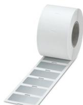
Etiqueta, Rolo, prata, não impresso, identificável com: THERMOMARK E.300 (D)/600 (D), THERMOMARK ROLL 2.0, THERMOMARK ROLL, THERMOMARK ROLL X1, THERMOMARK ROLLMaster 300/600, THERMOMARK X1.2, tipo de montagem: cola, Quantidade de plaquetas de identificação: 1000, altura do campo de texto: 25 mm, largura do campo de texto: 51 mm
