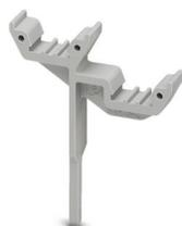
Porta-plaquetas, encaixável no borne a mola de dois níveis STTB 2,5, STTB 4, PTTB 2,5, PTTB 4, identificável com UC-TM 5, UC-TMF 5, UCT-TM 5, UCT-TMF 5, ZB 5 ou ZBF 5, cinza, não impresso, tipo de montagem: encaixar, altura do campo de texto: 10,5 mm, largura do campo de texto: 5 mm
