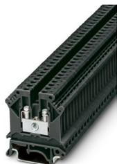
Borne de passagem, tensão nominal: 800 V, corrente nominal: 24 A, quantidade de conexões: 2, tipo de conexão: Conexão a parafuso, Bitola: 2,5 mm<sup>2</sup>, perfil de conexão: 0,2 mm<sup>2</sup> - 4 mm<sup>2</sup>, tipo de montagem: NS 35/7,5, NS 35/15, NS 32, cor: preto
